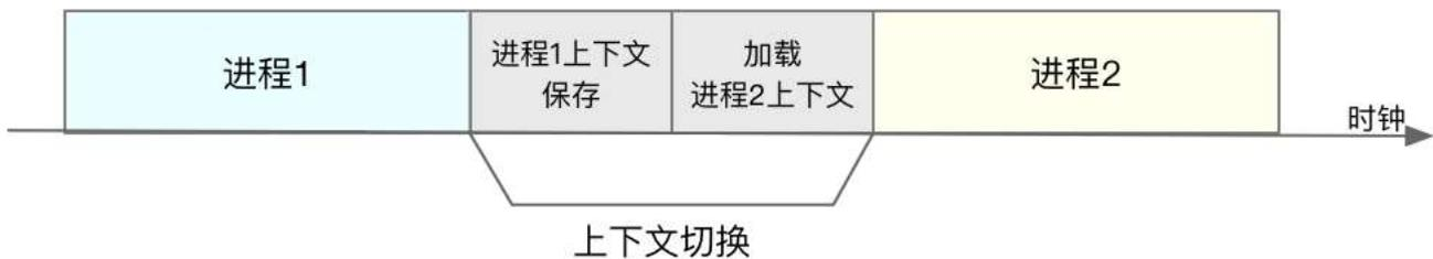
根据 [Tsunu](#) 的测试报告，每次上下文切换都需要几十纳秒到数微妙的 CPU 时间。这个时间还是相当可观的，特别是在进程上下文切换次数较多的情况下，很容易导致 CPU 将大量时间耗费在寄存器、内核栈以及虚拟内存等资源的保存和恢复上，进而大大缩短了真正运行进程的时间。这也正是上一节中所讲的，导致平均负载升高的一个重要因素。
